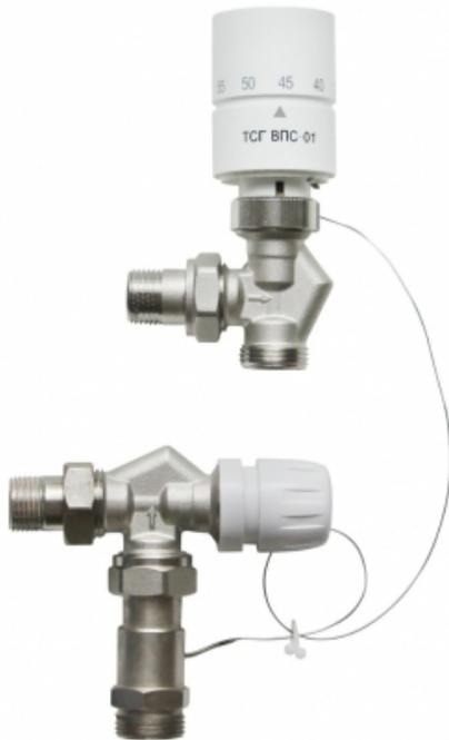
Основное назначение – подключение контура «Тёплого пола» к системе радиаторного отопления с принудительной циркуляцией. Подключение контура «тёплого пола» производится к подающей и обратной линии основной системы отопления. Циркуляция теплоносителя через контур «тёплого пола» обеспечивается за счет перепада давления создаваемого в радиаторной системе отопления. Установка обособленного циркуляционного насоса для контура «тёплого пола» не требуется.
